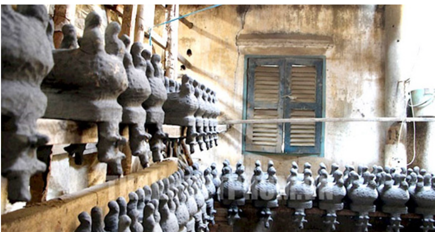
Những chiếc khuôn trong quy trình tạo ra lư đồng An Hội
