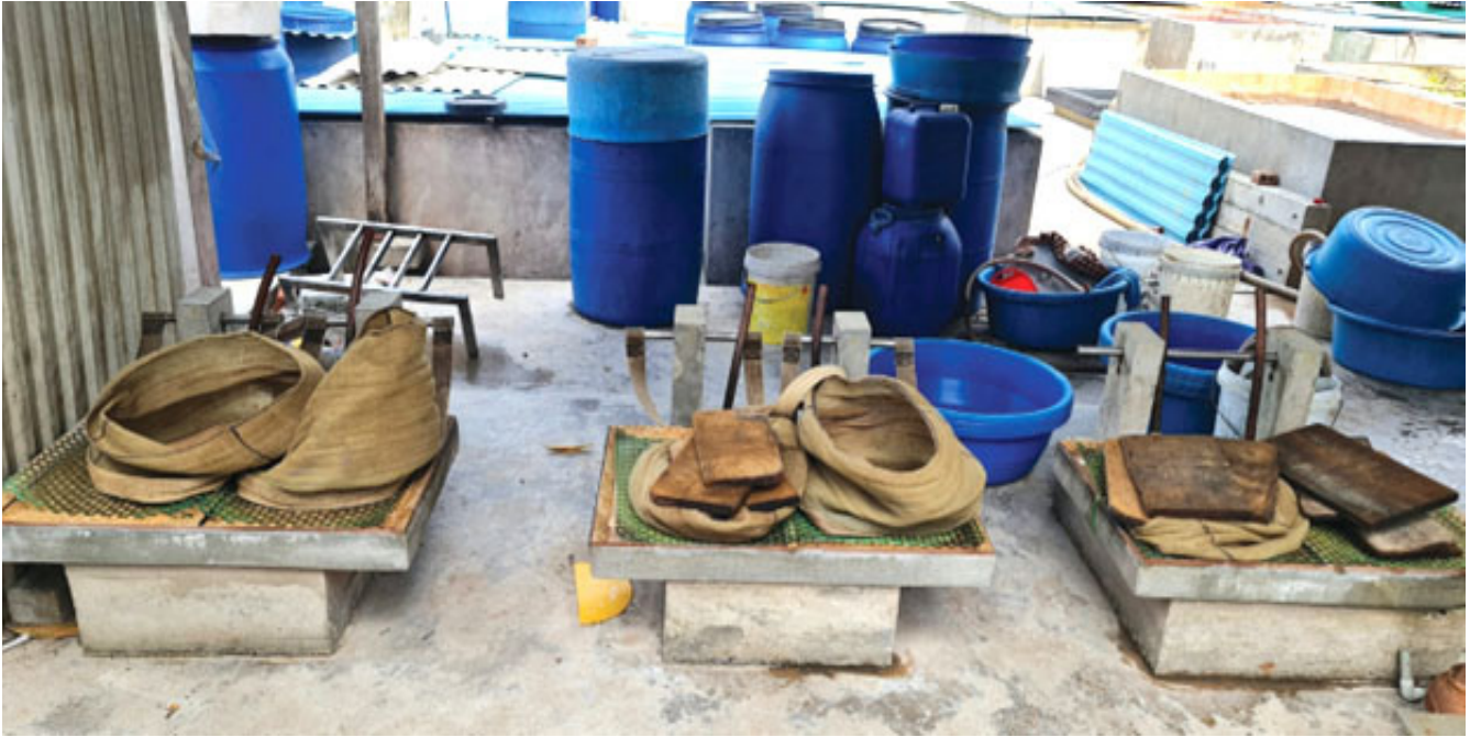
Dụng cụ ép nước mắ cốt do ông Mai Văn Năng tự chế tác.
