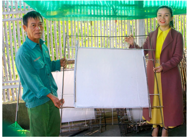
Các khuôn để tráng nước từ vỏ cây niệt tạo thành giấy dó.
