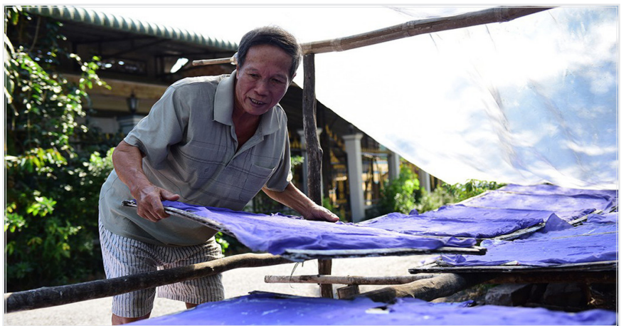
Phương pháp phơi bột phải phủ lên lớp giấy để bột đẹp màu và mau khô
