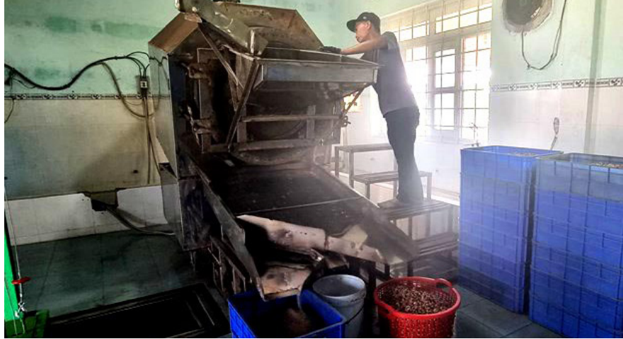
Máy rang hạt điều công nghiệp được hỗ trợ vốn từ Chương trình khuyến công quốc gia của Công ty Cổ phần Xuất Nhập khẩu Hưng Phát Ninh Thuận (thị trấn Khánh Hải, huyện Ninh Hải).
