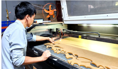
Công đoạn cắt sản phẩm bằng máy laser tại Công ty TNHH Dịch vụ Thương mại Quảng cáo và Nội thất Anh Khôi
