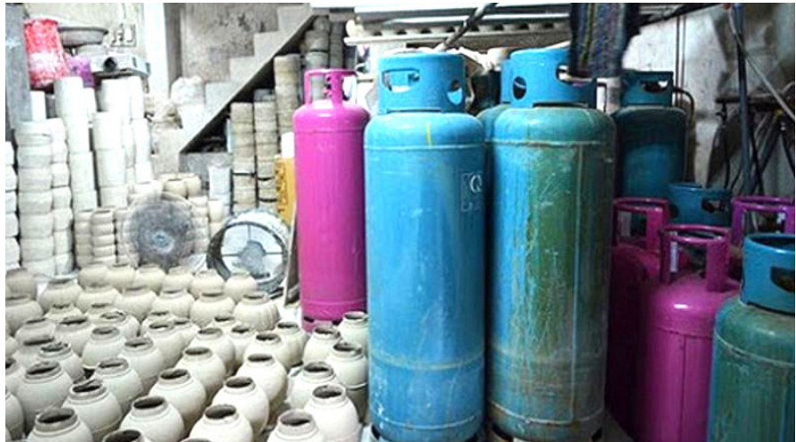
Nung gốm bằng khí gas giúp tiết kiệm năng lượng, giảm ô nhiễm môi trường.
