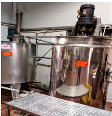
Hệ thống máy thủy phân mật ong với công suất chế biến 1.200 kg/mẻ.
