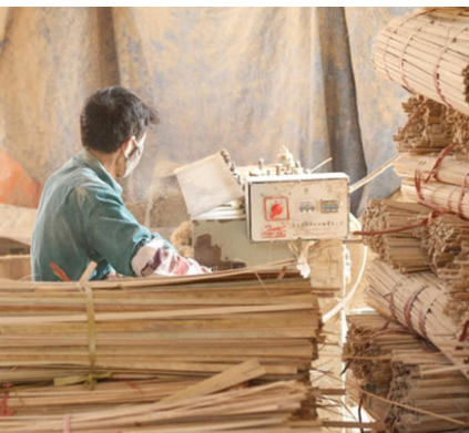
Những thanh tre, vầu được tách nhỏ ra để chuẩn bị đưa vào máy làm chân hương.
